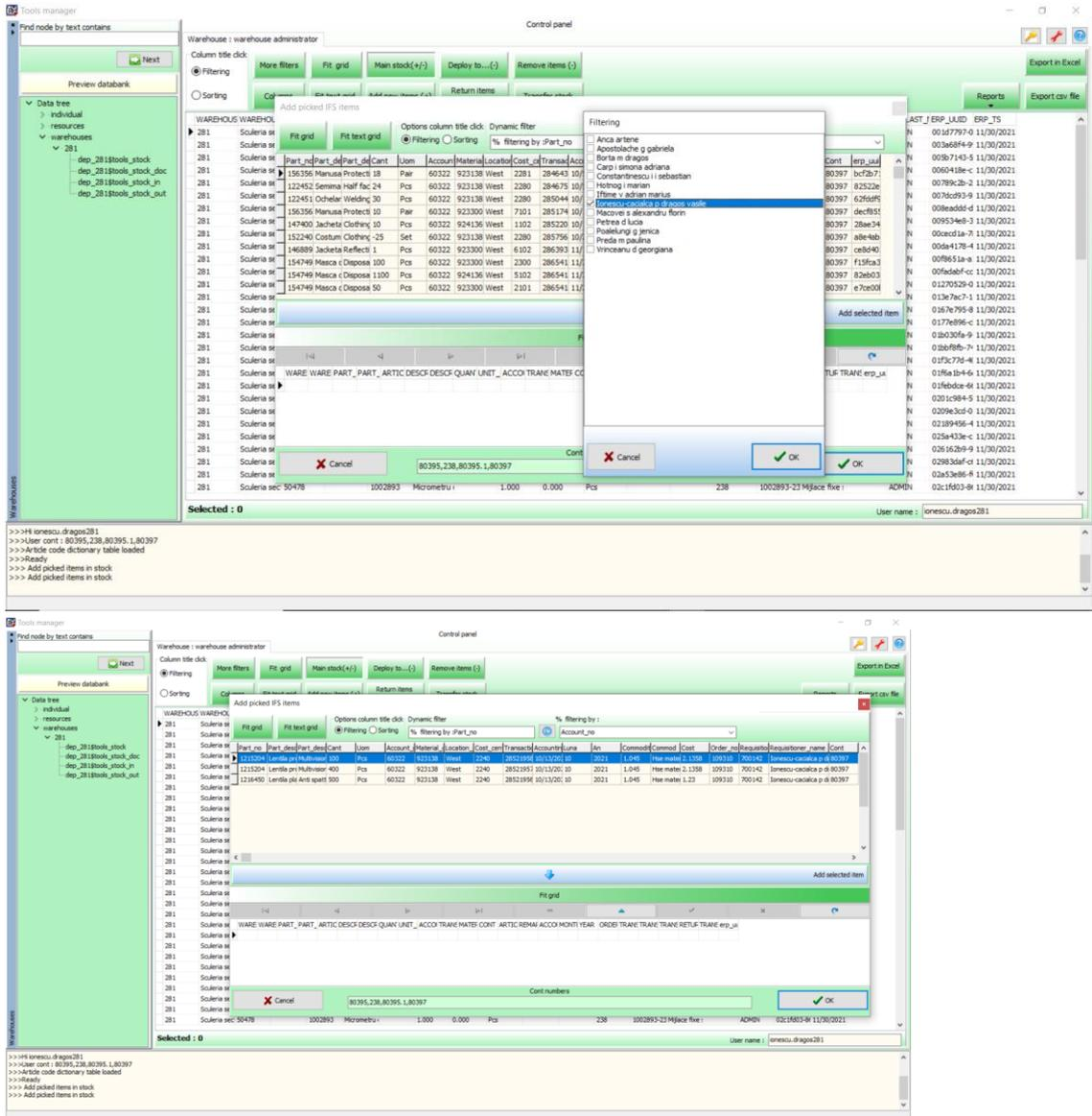
Dupa care am adaugat din grid-ul superior in grid-ul inferior doar articolele care au ajuns in depozit. Aplicatia determina automat cont-ul , dar userul are posibilitatea de a edita si al schimba. Ca regula generala in toate ferestrele de transfer date , daca userul face dblick pe caseta din coloana cont , aplicatia va trece prin toate conturile disponibile userului.
