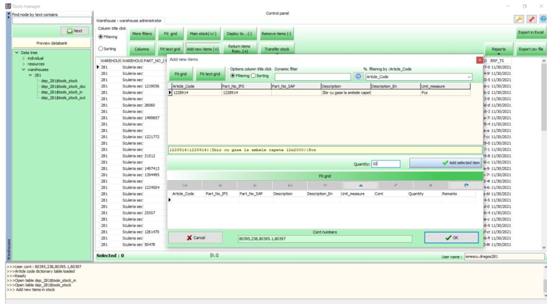
Daca user-ul doreste sa adauge un articol inexistent tin baza de date atunci este sufficient ca campul Article\_Code sa fie empty. Aplicatia va genera automat un nou articolecode si il va adauga in tabelul corespunzator din baza de date.
